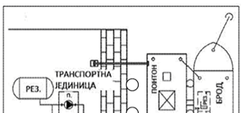
Slika 2. - Primer plutajuće stanice sa podukopanim tankovima na kopnu - transportna jedinica i merilo mogu biti na pontonu ili kopnu, a snabdevačka jedinica na pontonu
